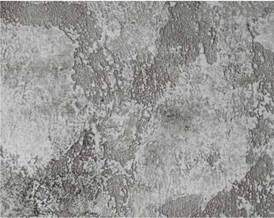
EFFETTO MARMO VELATO Decorazione ottenuta applicando 2 strati di Marmorino bianco a frattazzo. Finitura con Velature (A641). GLAZED MARBLE EFFECT Decoration obtained by applying 2 coats of white Marmorino by trowel. Finish with Velature (A641)
