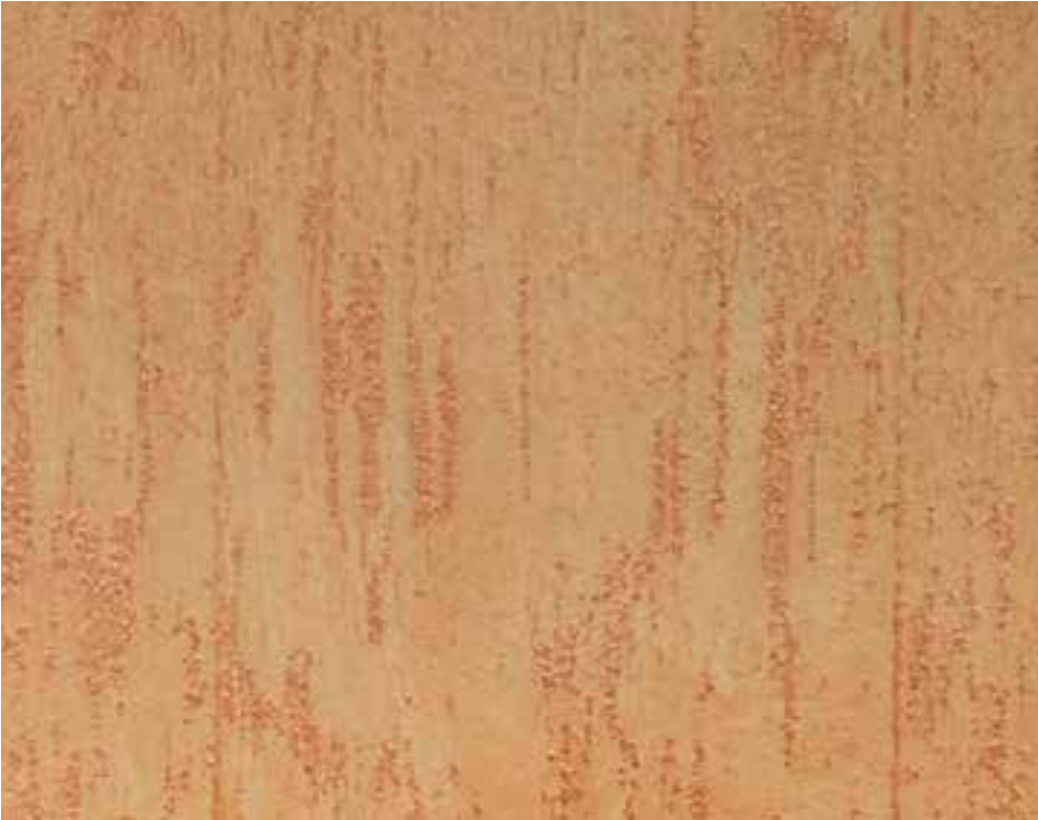
EFFETTO MARMO ANTICHIZZATO Decorazione ottenuta dalla combinazione di Marmo antico e Velature. Su fondo preparato con due strati di Marmo antico, asciutto e lucindato, applicare uno strato di Velature. ANTIQUE MARBLE EFFECT Decoration obtained from the combination of the Marmo antico and Velature products. Apply one coat of Velature to a dry and polished base made up of two coats of Marmo antico.
